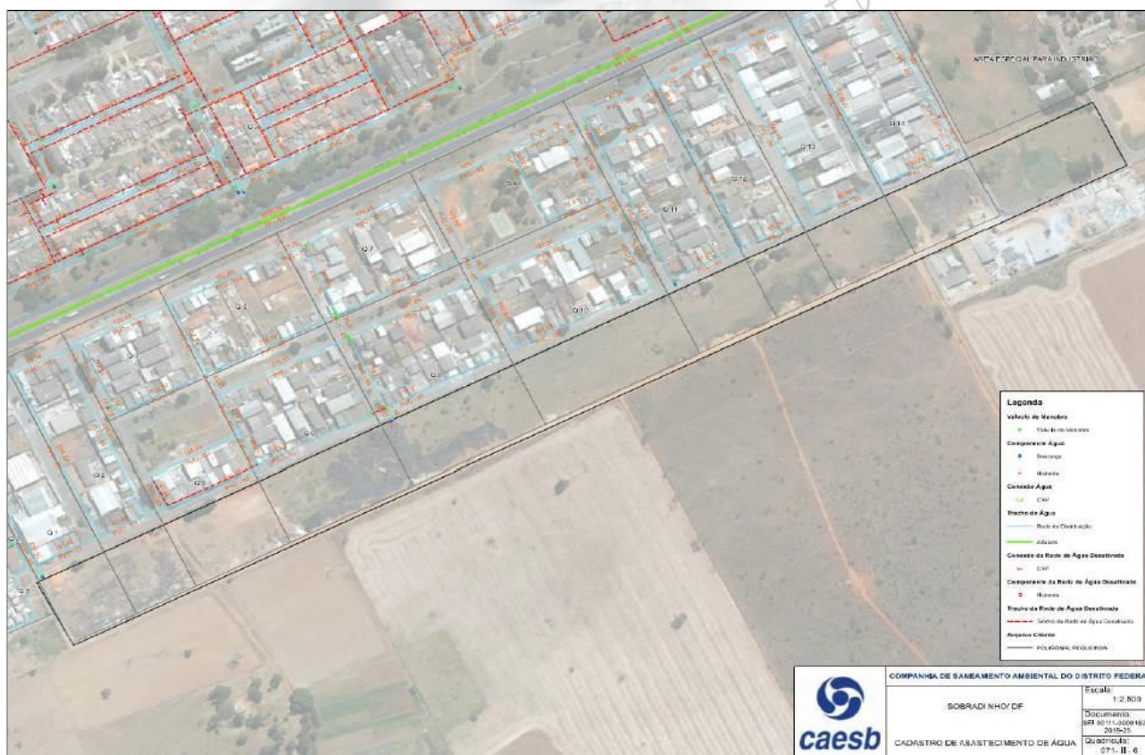
Figura 67: Croqui de interferência de rede de abastecimento de água.
