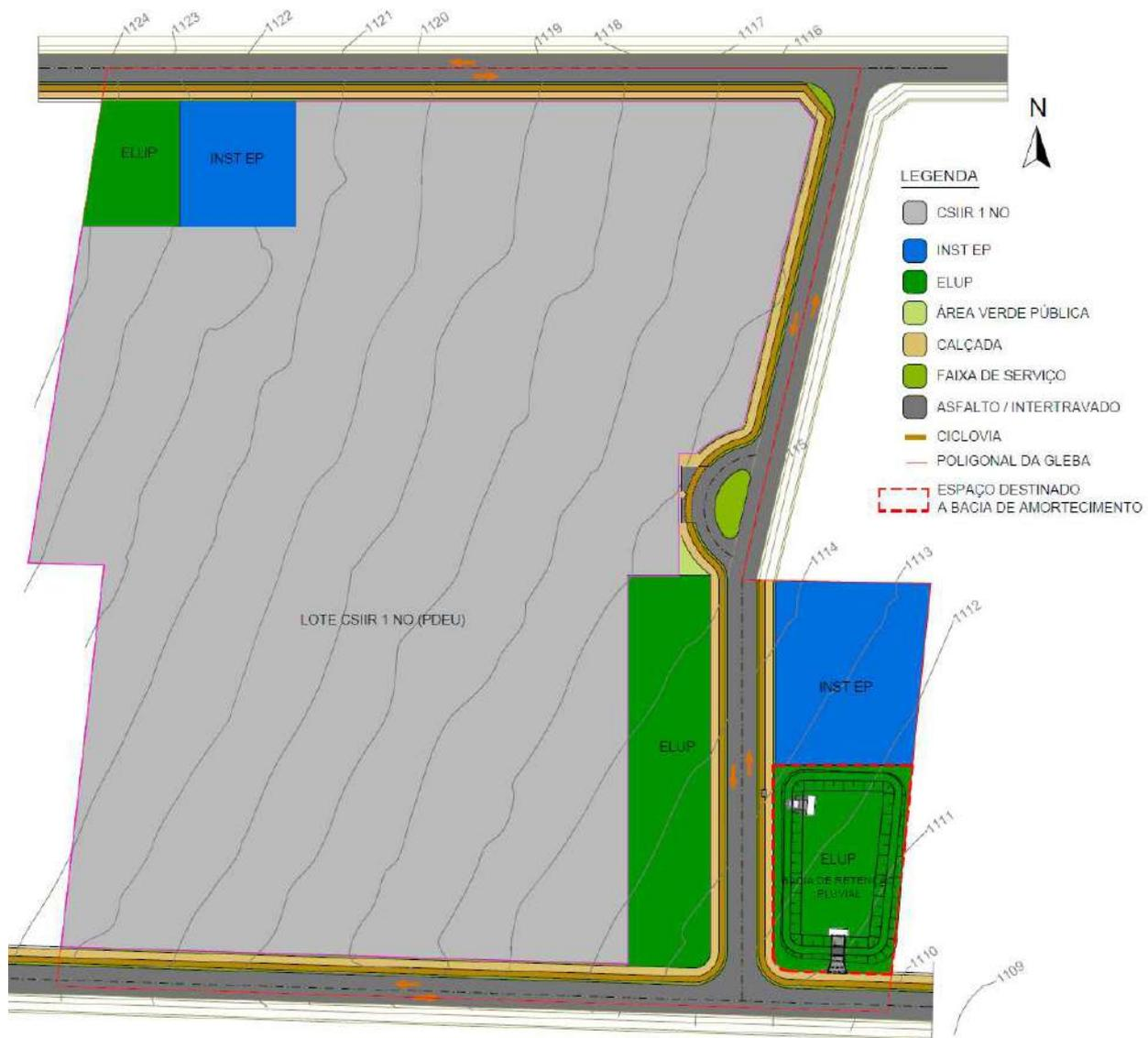
**Figura 04:** Croqui indicativo da bacia de amortecimento para águas pluviais.
